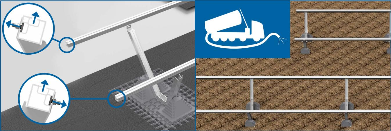
Roofgard-solar-RAIL auf die roofgard-solar-HOLDER montieren und anschliessend das Begrünungssubstrat auf die Dachfläche aufbringen.
